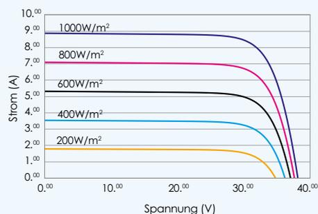
Durchschnittliche Effizienzverringering um 4,5% bei 200 W/m<sup>2</sup> gemäß EN 60904-1.
