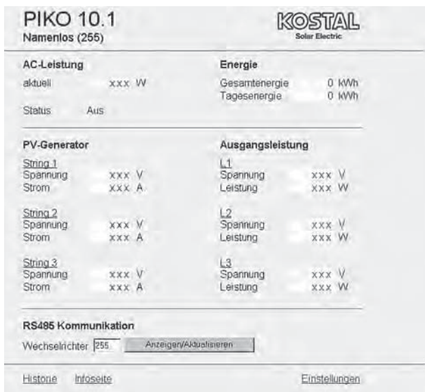
Abbildung 86: Hauptseite des Webservers (Die Anzahl der dargestellten Ein- und Ausgänge kann je nach Gerätetyp variieren.)
