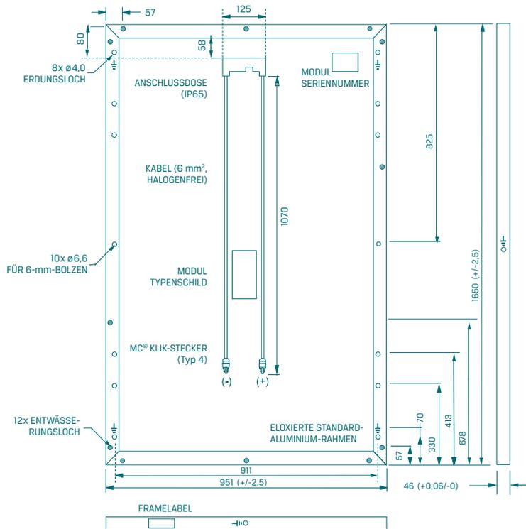
Alle Abmessungen in mm; Modulgewicht 18,6 kg
