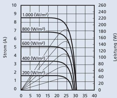
— Strom über Spannung — Leistung über Spannung
