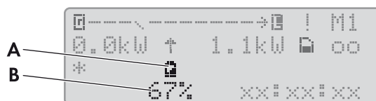
Abbildung 9: Batterieladezustand im Standardmodus (Beispiel)
