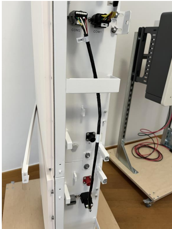
Abbildung 13: BMS-Leitung Battery Box 1 --> Battery Box 2
