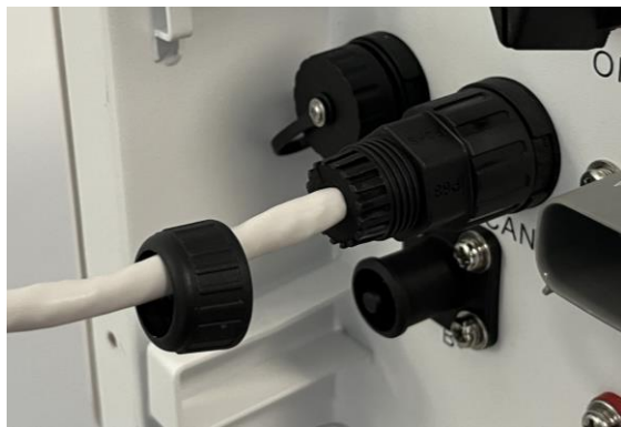
Abbildung 21: Montage BMS-Kabel zum Wechselrichter
