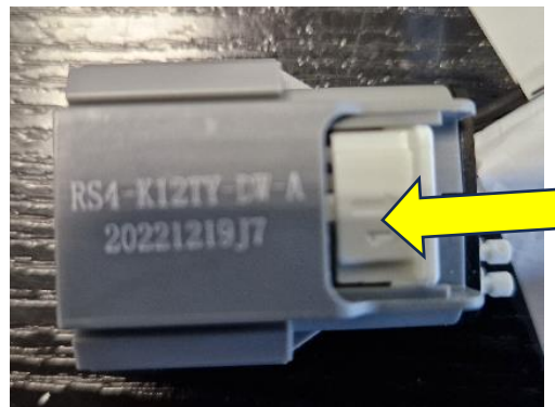
Abbildung 11: Arretierung entriegelt
