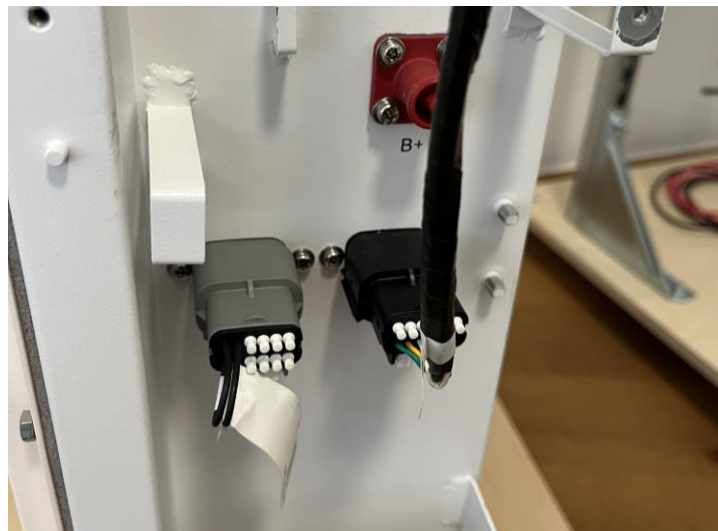
Abbildung 14: CAN-Bus Terminierung
