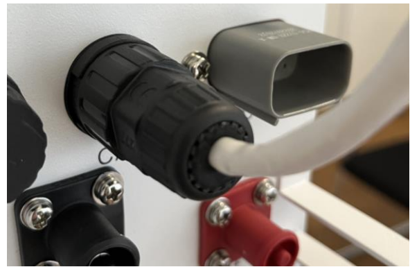
Abbildung 21: Montage BMS-Kabel zum Wechselrichter
