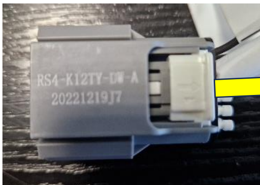
Abbildung 10: Arretierung verriegelt
