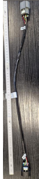
Abbildung 13: BMS-Leitung Battery Box 1 --> Battery Box 2
