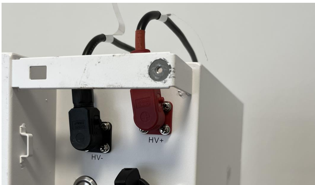
Abbildung 20: DC-Kabel zum Wechselrichter
