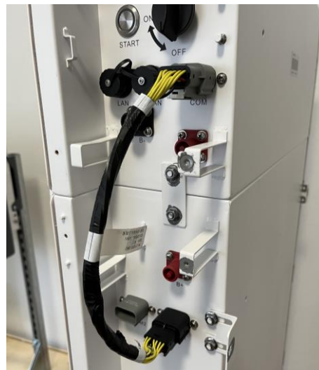
Abbildung 12: BMS-Leitung BDU --> Battery Box
