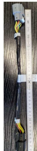
Abbildung 12: BMS-Leitung BDU --> Battery Box
