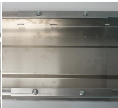
Abbildung 13: Verlängerung und Verschraubung Grundschiene 230 - 90
