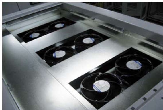
Bild 43: Lüfter für den Leistungselektronik-Block
