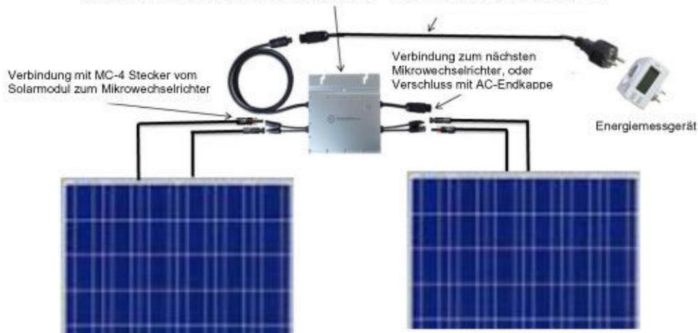
Verwendbare Solarmodule von 200 – 350 Watt
