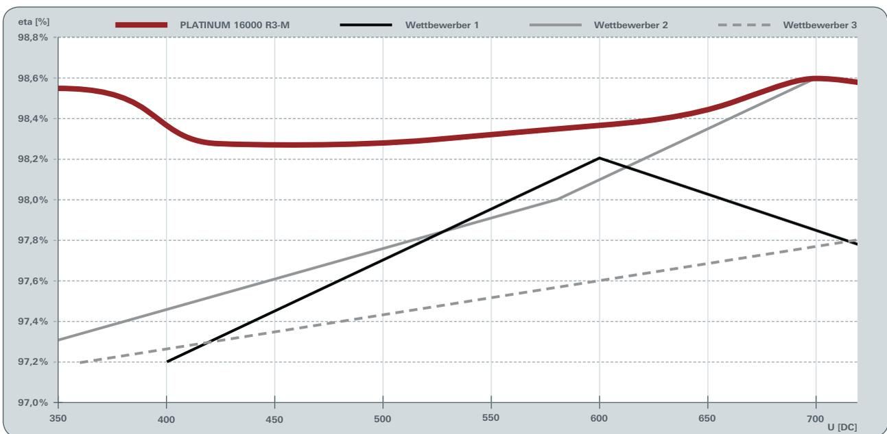
Hoher Wirkungsgrad über den gesamten MPPT-Spannungsbereich dank innovativer DUAL-X®-Technologie.
