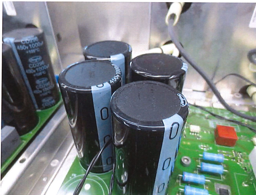
2. Verbrauchte/gealterte Elektrolytkondensatoren
