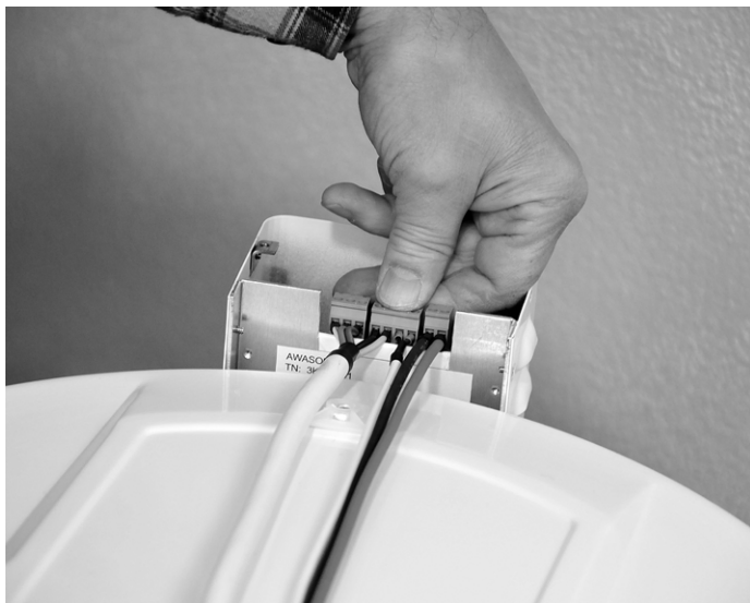
Abb. 9 Den Speicher-Kabelbaum einfach im Regler einstecken
