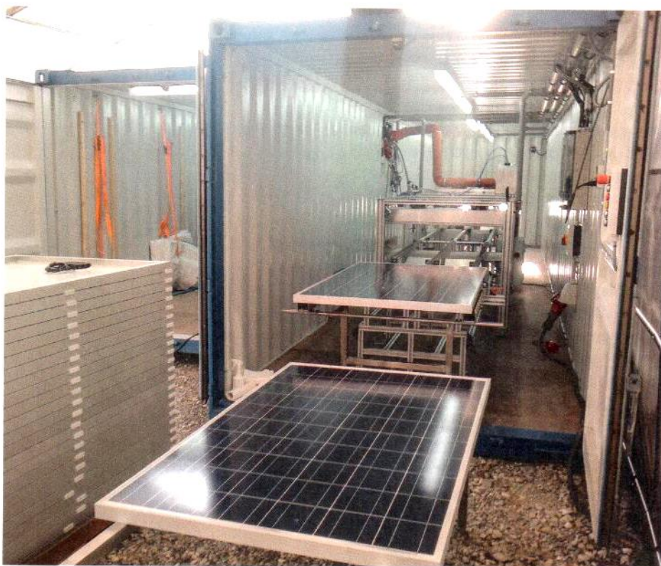
Ein spezieller Container erlaubt die schnelle Beschichtung von Modulen vor der Montage im Solarpark.
