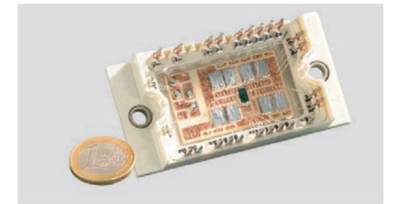
**Das Herz des Wechselrichters - intelligente Technologie auf kleinstem Raum!**
