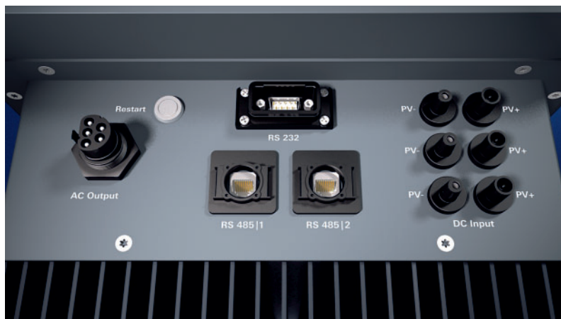
Plug&Play-Anschlüsse am Wechselrichter
