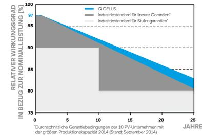
Mindestens 97% der Nennleistung innerhalb des ersten Jahres. Danach max. 0,6% Degradation pro Jahr. Mindestens 92% der Nennleistung nach 10 Jahren. Mindestens 83% der Nennleistung nach 25 Jahren. Alle Daten innerhalb der Messtoleranzen. Volle Produkt- und Leistungsgarantien entsprechend der jeweils gültigen Garantien der Q CELLS Vertriebsgesellschaft Ihres Landes.
