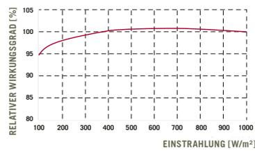
Die typische Änderung des Modulwirkungsgrades bei einer Einstrahlung von 200 W/m<sup>2</sup> im Verhältnis zu 1000 W/m<sup>2</sup> beträgt -2% (relativ) (bei 25 °C, AM 1,5 G Spektrum).
