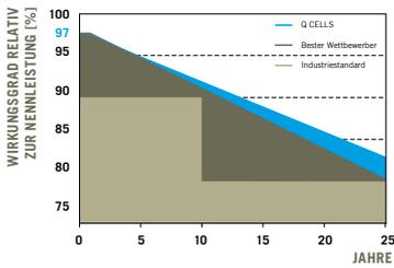
Mindestens 97% der Nennleistung innerhalb des ersten Jahres. Danach max. 0,6% Degradation pro Jahr. Mindestens 92% der Nennleistung nach 10 Jahren. Mindestens 83% der Nennleistung nach 25 Jahren.
