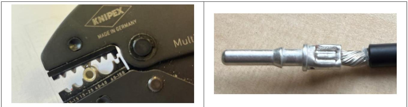
Abbildung 22: Batteriestecker Dornpressung
