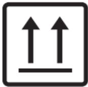
Der Wechselrichter muss stets so transportiert und gelagert werden, dass die Pfeile auf der Verpackung nach oben zeigen.
