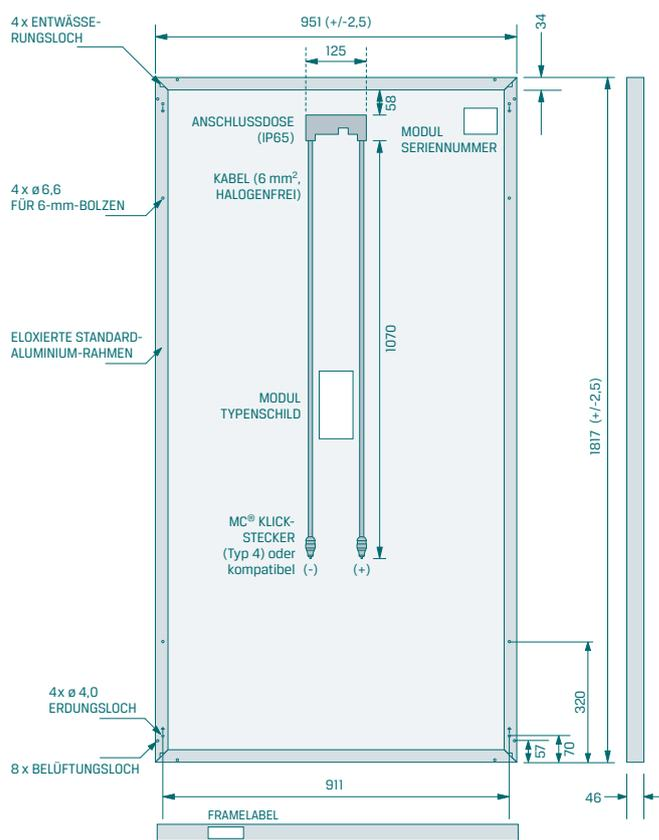
Alle Abmessungen in mm; Modulgewicht 20,1 kg
