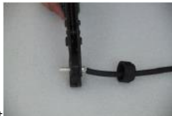
Abbildung 10: Stecker-Überwurfmutter mit Kabel verbinden
