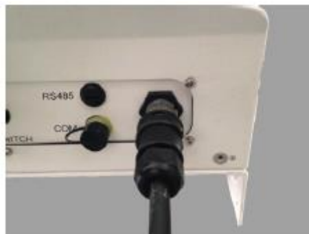
Abbildung 17: Stecke den Netzstecker in den Solis-6K
