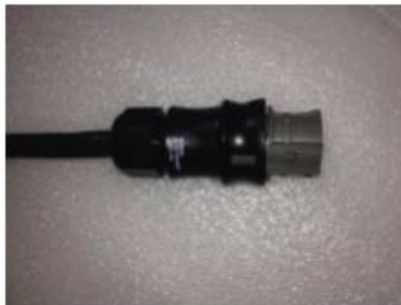
Abbildung 16: Verschluss auf dem Netzstecker
