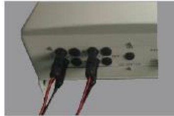
Abbildung 12: DC Stecker mit Wechselrichter verbinden
