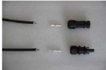
Abbildung 8: Stecker zerlegt
