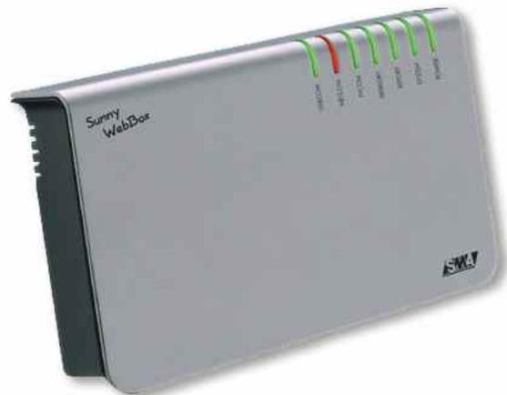
Bis zu 50 verschiedene Wechselrichter können mit Sunny WebBox überwacht werden. Die Datenübertragung erfolgt über eine RS 232/485 Leitung oder Funk. Sunny WebBox speichert die Daten auf einer austauschbaren Speicherkarte. Die serienmäßige Ethernet-Schnittstelle übernimmt die Verbindung zum PC oder zum Netzwerk.
