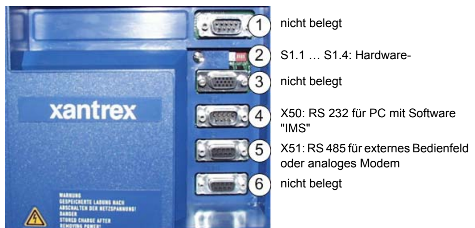
Abbildung 3-4 Sub-D-Anschlüsse und DIL-Schalter
