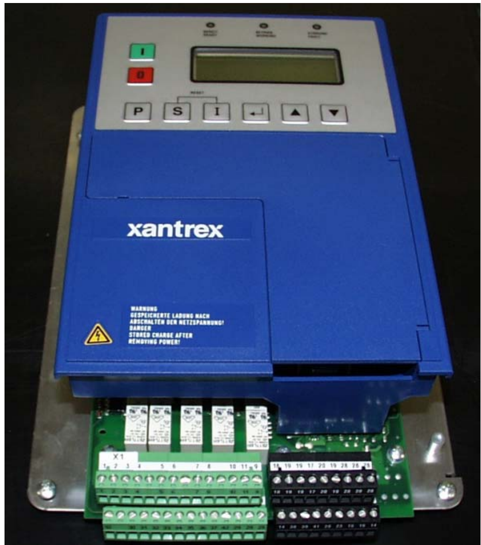
Abbildung 2-14 Steuerelektronik mit Abdeckung und Display
