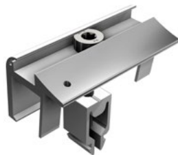
Endklemmen ohne Erdungspin für Rahmenhöhe 28 mm – 45 mm
