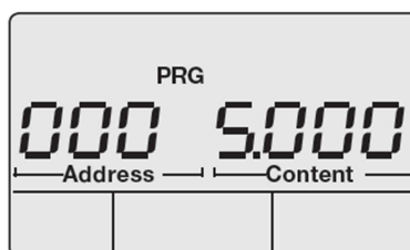
Abb. Anzeigenbeispiel „Programmier-Modus“, Adresse 000 mit dem Inhalt 5.000.
