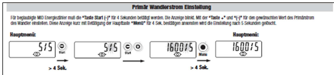
Abb: 2-8 Parametrierung Wandlerverhältnis
