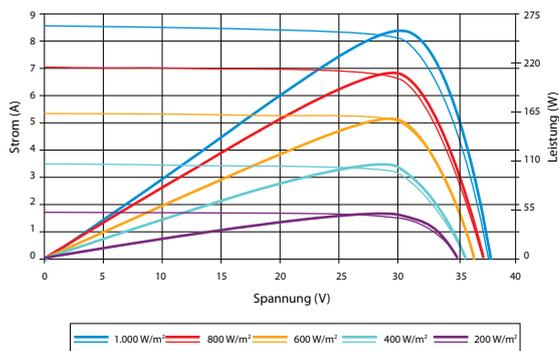
Hervorragende Leistung bei schwachem Licht: bei einer Strahlungsintensität von 200 W/m<sup>2</sup> (Luftmasse 1,5, 25 °C) ist ein relativer Modulwirkungsgrad von mehr als 96,5% gegenüber Standardtestbedingungen (1.000 W/m<sup>2</sup>) erreichbar.
