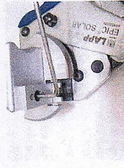
mit dem Inbusschlüssel lösen und herausschrauben, gelöste Schraube und Zusat locator entfernen
