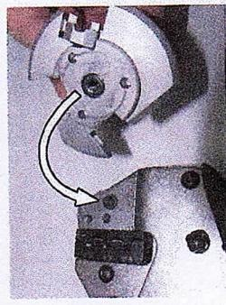
Locator aufdrehen bis er einrastet und mit dem beiliegendem Inbusschlüssel leicht anziehen.
