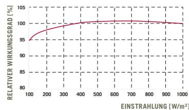
Die typische Änderung des Modulwirkungsgrades bei einer Einstrahlung von 200 W/m<sup>2</sup> im Verhältnis zu 1000 W/m<sup>2</sup> beträgt -2% (relativ) (bei 25 °C, AM 1,5 G Spektrum).
